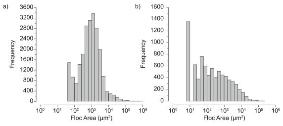
Fig. 2. Floc size distribution for a) 2D floc area ( $\mu m^2$ ) and b) 3D floc volume ( $\mu m^3$ ).
